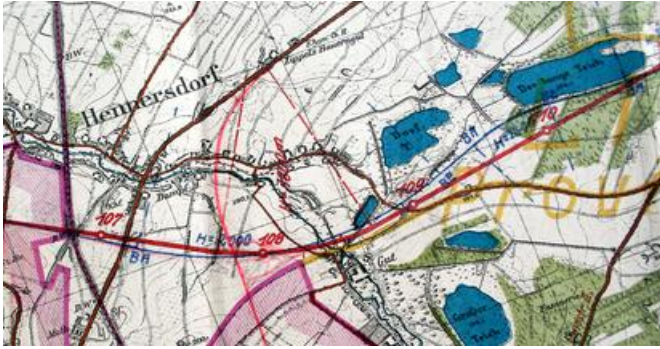
Abb.3: Um nicht unnötig Acker und Waldflächen zu zerschneiden, versuchte die BAR Görlitz, durch die Verziehung der Linienführung nach Norden, näher an den Dorf- und Langer Teich, den Grundbesitzern entgegenzukommen. Die geschwungene Trasse, durch Kurven von 2000 m Halbmesser entsprach den damaligen Gestaltungsansichten. Das Linienblatt wurde bei der Besprechung am 21.07.1938, dem anwesenden Görlitzer Oberbürgermeister Herrn Damrau übergeben. Der Vorschlag wurde vom GI nicht genehmigt. Der Ausschnitt ist aus zweierlei Gründen interessant. Er zeigt bei Hennersdorf die von Anfang 1938 beabsichtigte Linienführung und die im Oktober 1938 vom GI befürwortete leichte Südverziehung mit der geplanten Anschlussstelle Görlitz Ost (roter Bleistift). Aus Platzgründen und der besseren Einsicht des Autofahrers auf die Anschlussstelle musste die Linienführung entsprechend abgeändert werden. Es ist die einzige Darstellung der Anschlussstelle Görlitz, die gefunden werden konnte.
