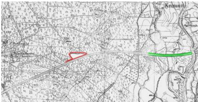
Abb. 15: Auf dem Messtischblatt von 1943 ist die Seitenentnahme in der Kromnitzer Heide bei der messtechnischen Neuaufnahme mit beachtet worden. Nach einer Schätzung vor Ort 2004, wurden ca. 200.000 bis 280.000 Kubikmeter Erdreich entnommen. Dieses wurde zum Aufschütten der Böschungen 1939 im Bobertal sowie Mitte 1940 im Queistal verwendet. Der Transport erfolgte mittels einer Feldbahn. Ausschnitt aus Messtischblatt 4659 Ausgabe 1943.
